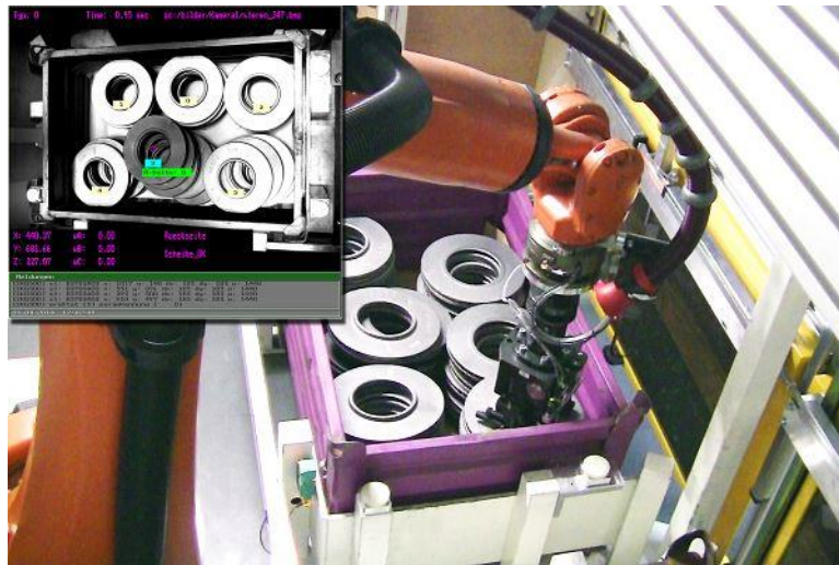
Bild 1: Das stationäre 3D-Erkennungssystem SKG500 für die Lage- und Positionsbestimmung von Reibringen in Schwergutbehältern ist oberhalb der Entnahmebucht installiert.
